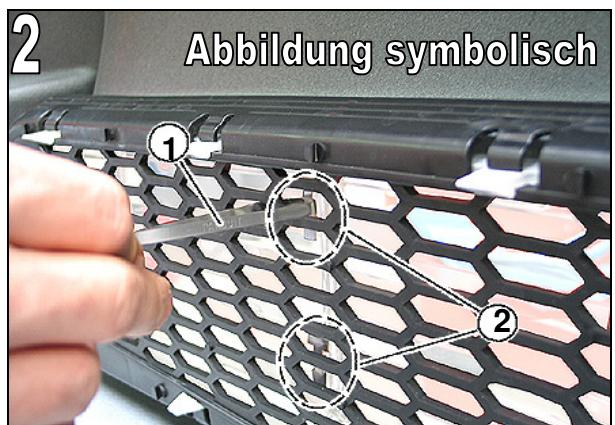
Kunststoff Kabelbinder können von vorne befestigt werden. Bei beiden Varianten, ist überstehendes Material der Kabelbinder abzutrennen.
