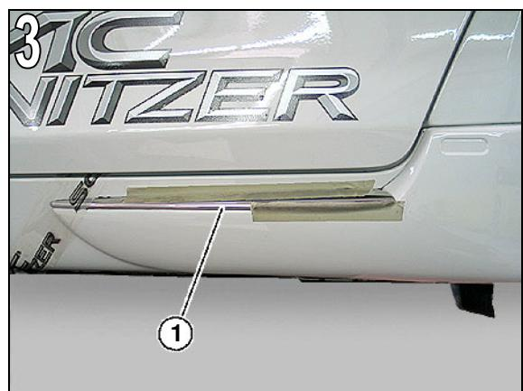
Das AC Schnitzer Chromeline Set Designelement ist nun fertig montiert.
